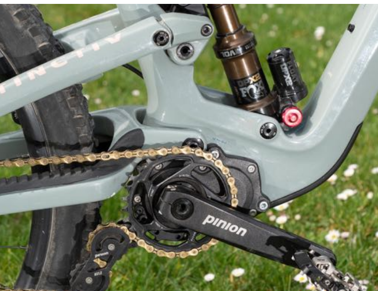
La suspension Puma permet de réduire au maximum l'inertie des pièces mobiles avec de petits basculeurs et un amortisseur en position inversée.
