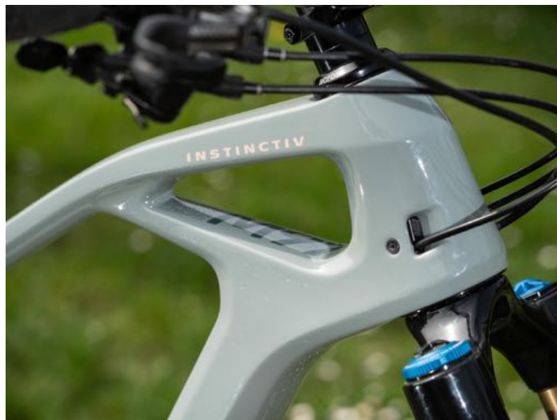
La douille de direction est massive avec un design de tube supérieur assez spécial qui permet de loger un porte-bidon.
